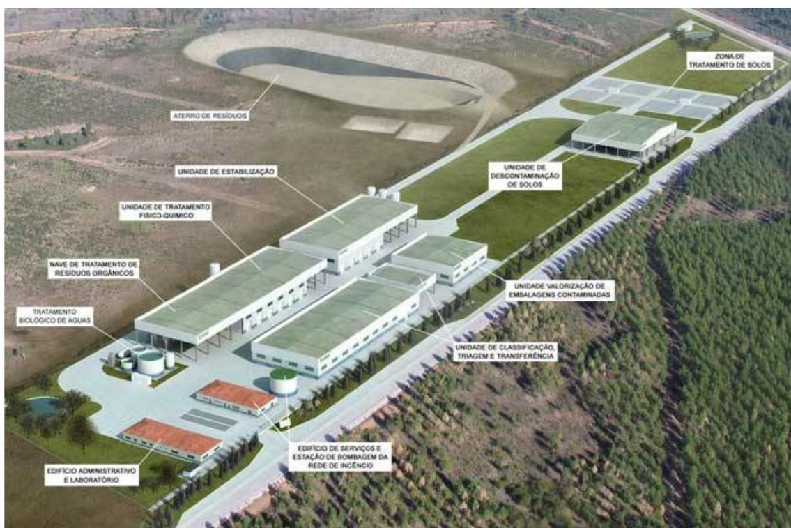
Figura 31 – Representação esquemática de um CIRVER
